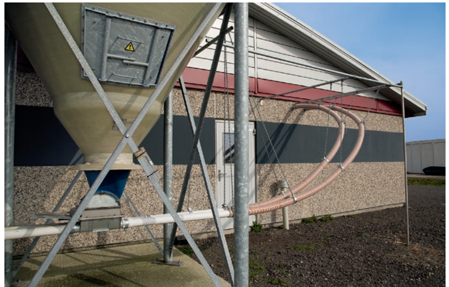
Uso de FlexVey PUR en combinación con un tubo de FlexVey rígido
