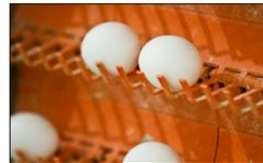
El transporte especial del EggCellent es hecho de cadenas conectadas modulares de plástico, que no se estiran y que no requieren lubricación. Estas piezas de cadena plásticas modulares se caracterizan por un acolchado suave para protección de impacto a los huevos y transporte cuidadoso.
