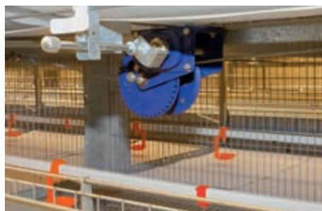
Tornillo instalado en el centro para el ajuste en altura de la línea de bebederos
